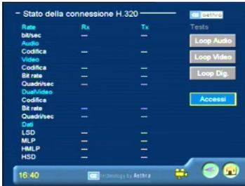
Inoltre posizionandosi sull'icona "Accessi" e premendo OK si entra in una pagina di diagnostica Avanzate dove è possibile monitorare più in dettaglio lo stato dei singoli accessi ISDN:
