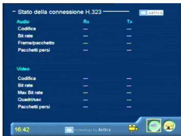
dalla quale è possibile controllare una serie di parametri relativi ad una connessione Audio e Video IP: bitrate, tipo di codifica, Frame/pacchetto (per l'Audio), Quadri/Sec. ( per il Video ), numero di pacchetti persi.
