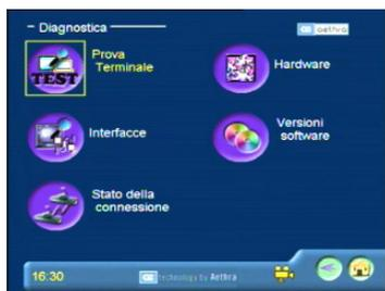
In questa sezione è possibile accedere ai vari menù di diagnostica che riguardano lo stato della connessione, le interfacce utilizzate, l'audio, il video e le varie componenti hardware del sistema.
