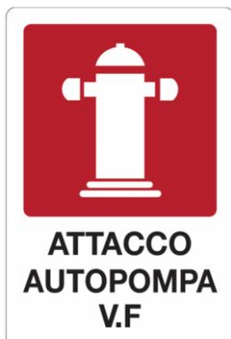
Figura 7 – cartello segnaletico attacco per autopompa del Vigili del fuoco
